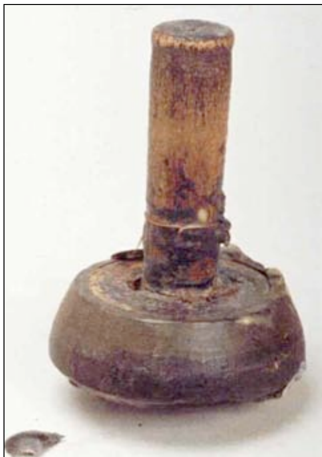
Afb. VI.13. Mal voor een bonangketel. De opstaande paal wordt in de grond gestoken, zodat de paddestoelvormige mal de binnenkant van de toekomstige ketel aangeeft. Hieromheen wordt een waslaag aangebracht. Als de waslaag hard geworden is wordt deze vervolgens verwijderd door het wasmodel in twee helften te snijden, waarna deze weer met een soldeerboutje aan elkaar worden gesmolten. (zie ook hst.VI, noot 128) Afkomstig uit Minangkabau, Kota Gedang of Silungkang, verworven in 1913. (WM 020965)
